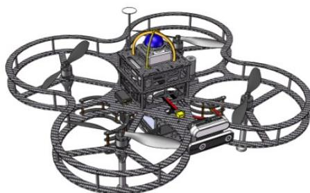
无人机配备双目深度摄像头、2d激光雷达、机载计算机等模块，所有模块已完成软、硬件接口连接，无需额外配置操作。
